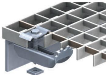
Стандартное крепление, состоящее из верхней части скобы, нижней части – зажима, шестигранного болта М8х60 и четырехгранной гайки М8.
