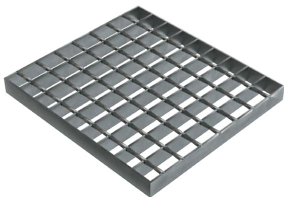
Сварной настил изготавливается из малоуглеродистой или нержавеющей стали, в которой точки пересечения несущей полосы и связующего (покровного) прутка соединены с помощью кузнечно-прессовой сварки при высоком давлении. Это образует чрезвычайно прочную и устойчивую конструкцию, выдерживающую длительные, динамически нагрузки. Далее настил покрывается горячим цинком.
