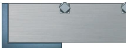
**Тип А** – высота обрамления равна высоте несущей полосы решетчатого настила.
