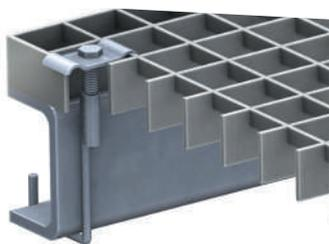
Крепление с помощью крючка, состоящее из верхней части скобы или тарелки, удлиненного крючка из выгнутого круглого прутка с приваренной к нему длинной гайкой в виде гильзы и шестигранного болта М8.
